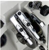
打线凸轮外置 (穿线、维修更方便)
