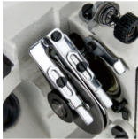
打线凸轮外置 (穿线、维修更方便)
